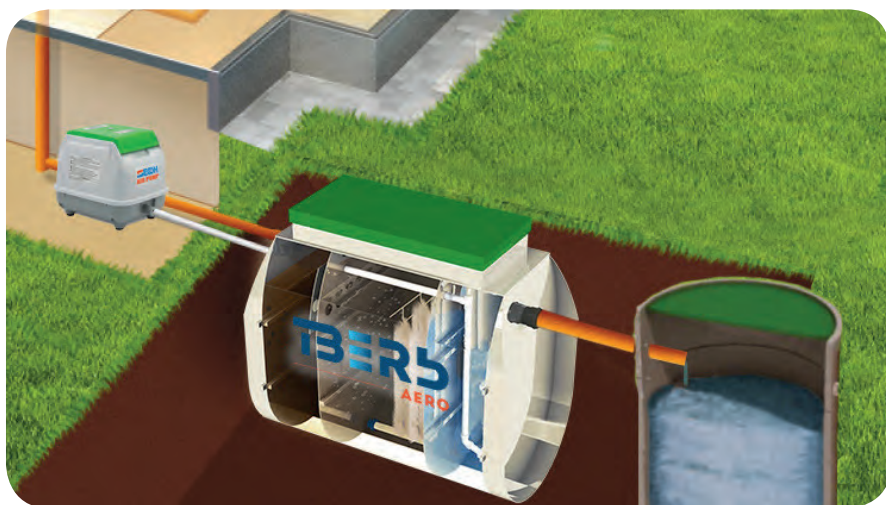
2. Схема с самотечным отводом очищенной воды
