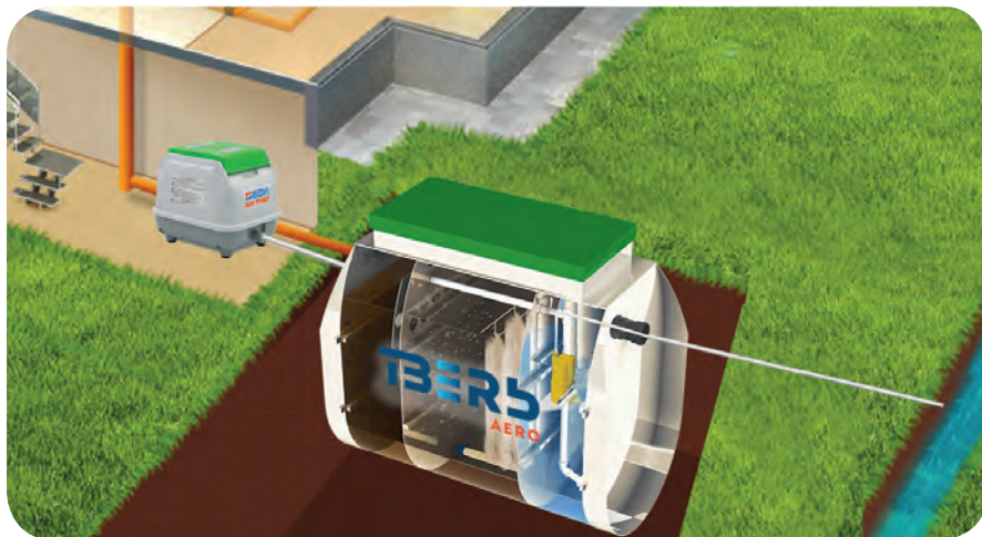
1. Схема с напорным отводом очищенной воды
